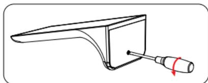
1. Schraube lösen und Kappe öffnen
