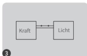
3 Die Trennung ist erfolgt, sobald das Licht 10 Mal schnell blinkt.
